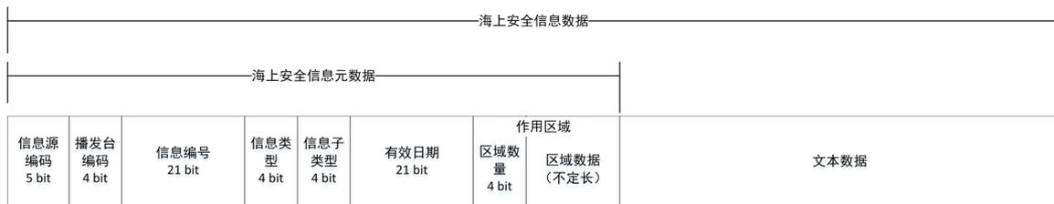
图 B.1 海上安全信息数据电文结构
