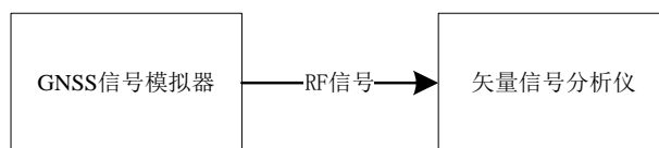
图 7 载波与伪码相干性测试框图
